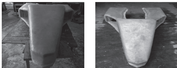
(a) 刷完树脂后的车身; (b) 脱模完成后的车身 a—刷完树脂后的车身; b—脱模完成后的车身
